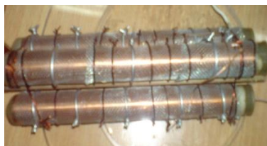
Сурет 4.4 – Разряд тізбегінің параметрлерін басқару мүмкіндігі бар секциялық электроды бар разрядтық озонатор камерасының фотосуреті
