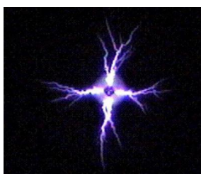
Сурет 1.9 - Жеке микроразрядтардың фотосуреттері (ICCD) [24].
