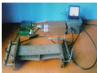
Сурет 4.2 – Шекті секцияланған электродпен тосқауыл камерасының фотосуреті
